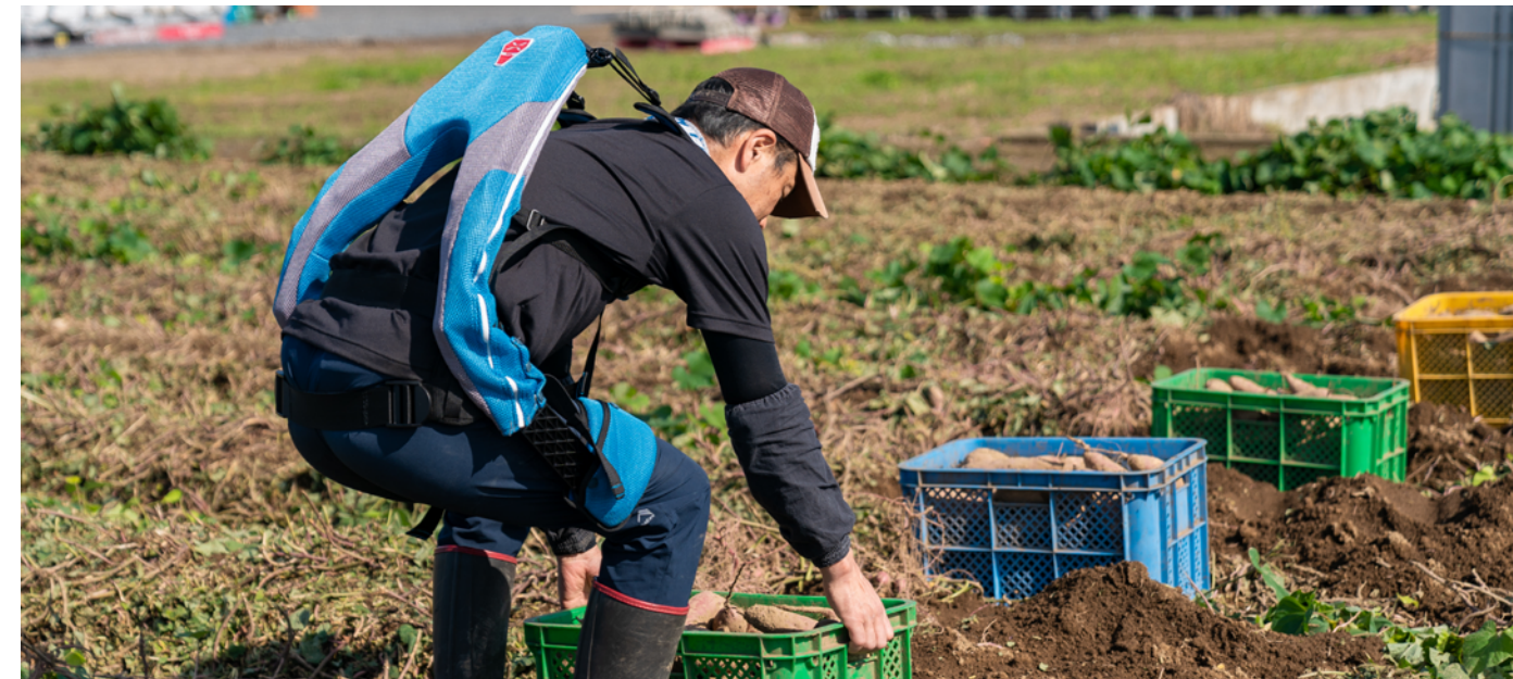
電池が不要ながら力強いアシスト力を実現した同社のアシストスーツは、様々な業界で中腰作業や重量物運搬作業に活用されている
